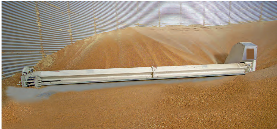
Figura 27: Coclea raccoglitrice (fonte Contarp Inail)
